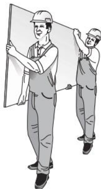
Figura 11 - Transporte manual de chapas.
