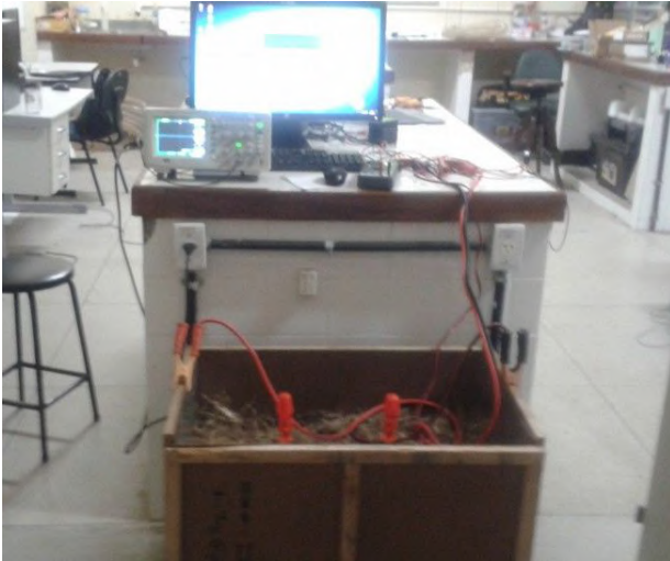
Figura 1 -Amostra de solo preparada com os recursos necessários para a medição de sua condutividade elétrica.
