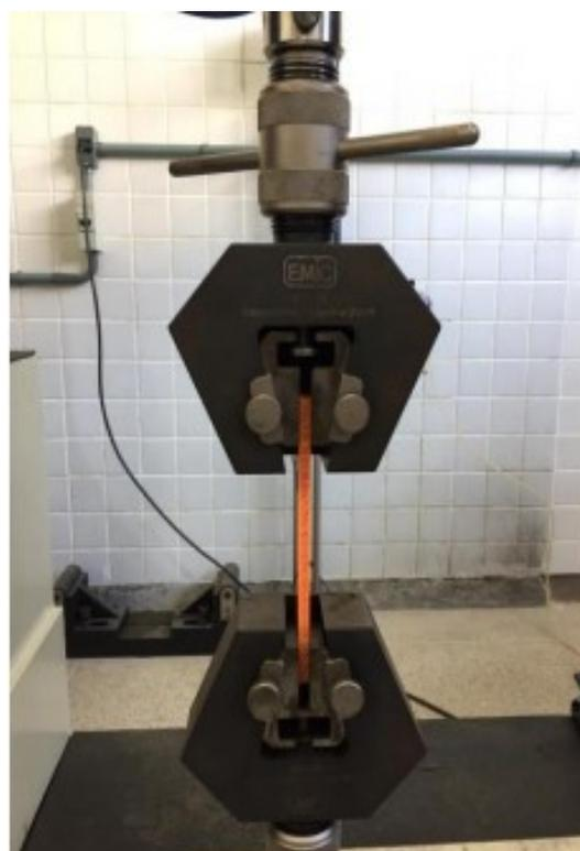
**Figura 1** - Ensaio de tração (acervo dos autores).
