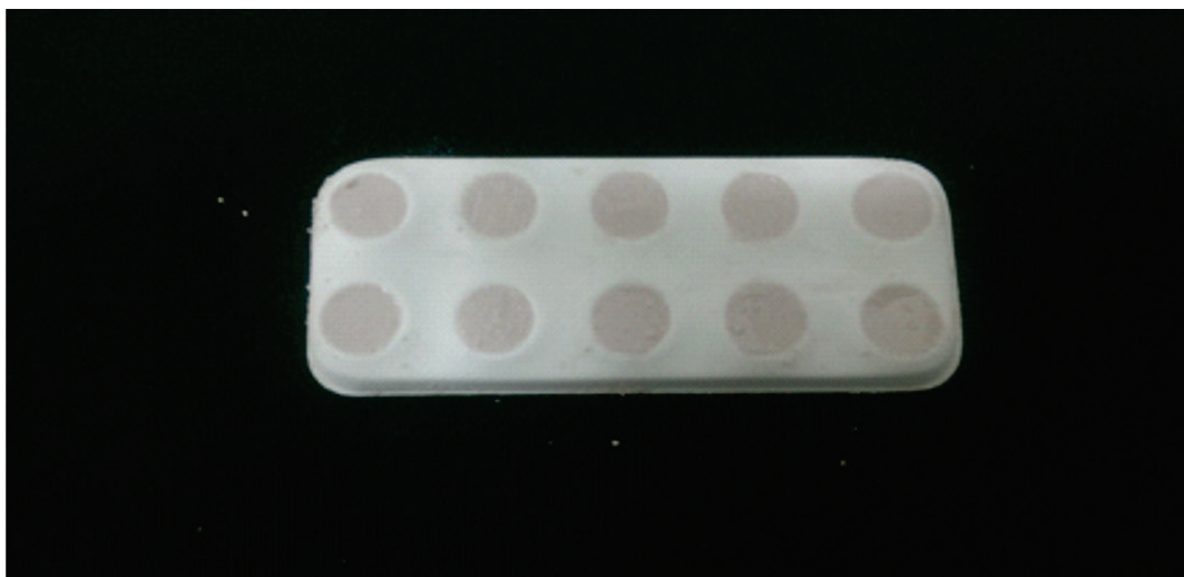
Fig 2. Corpo-de prova Gesso Tipo IV microgranulado. Característica do material: Homogêneo, Uniforme, Liso e Brilhante.
