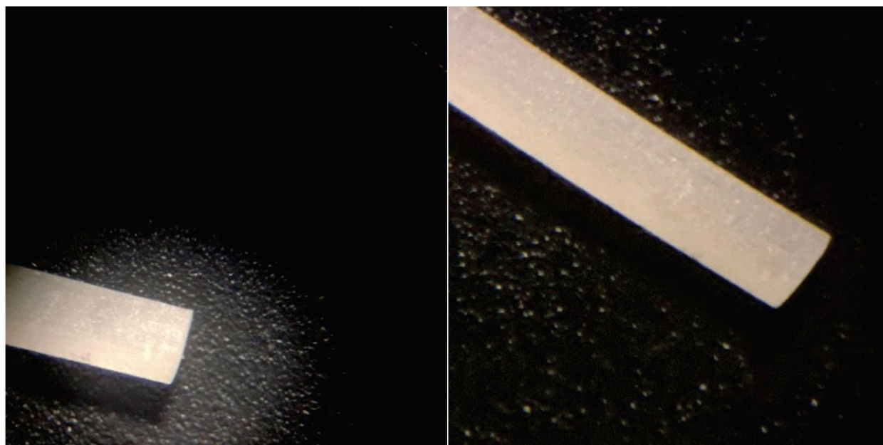
Figura 10 - Imagem Microscópica 3x de aumento do grupo controle. Pino de Fibra de Vidro (White Post FGM, Brasil).
