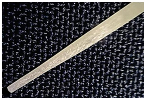
Figura 3 - Imagem Microscópica 1x de aumento do grupo III. Pino de Fibra de Vidro após polimento com disco de lixa da cor escura para a cor mais clara (White Post FGM, Brasil).
