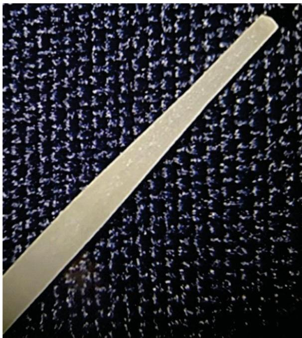
Figura 2 - Imagem Microscópica 1x de aumento do grupo II. Pino de Fibra de Vidro após polimento com escova de carbetto de silício (White Post FGM, Brasil).
