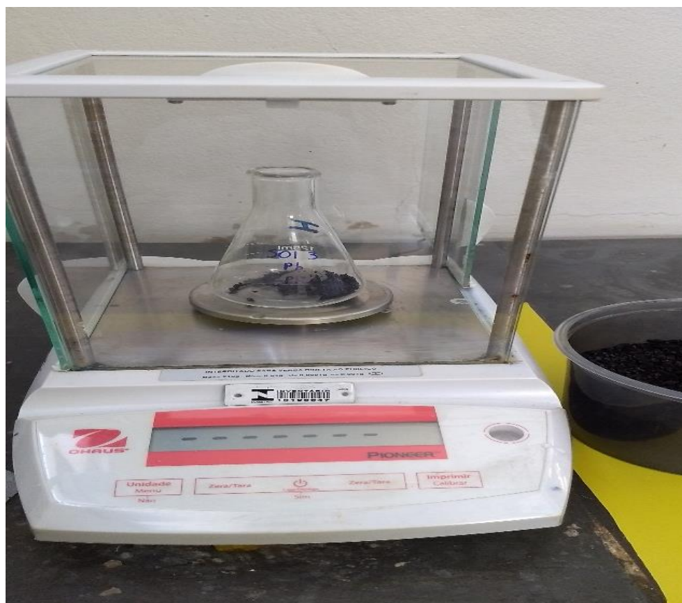
Figura 2 - Do lado esquerdo o processo de pesagem do carvão e da direita ajuste do pH.
