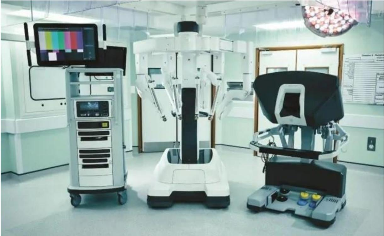
**Figura 1.** Componentes do sistema robótico Da Vinci Xi (fabricado pela Intuitive Surgical): *vision cart*, *patient cart* e console do cirurgião.
