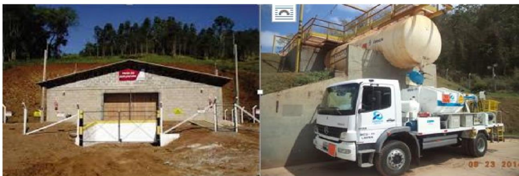
Figura 7: Paiol do granulado ANFO (esquerda) e paiol de Emulsão bombeada (direita) Fonte: Orica (2016)
