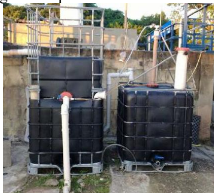
FIGURA 4: Biodigestor experimental de contêiner IBC modelo
